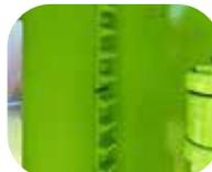
Pour un broyage plus fin sur TSP180 et TMJ1160 : avec 1 rangée de contre marteaux en U dentés boulonnés.
