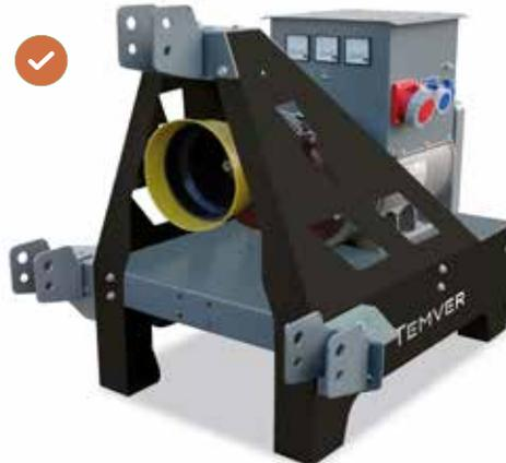
• **Cadre de base solide** fabriqué en tôle, peinte avec une peinture epoxy bicomposante, avec attelage à 3 points catégories 1, 2 et 3.
